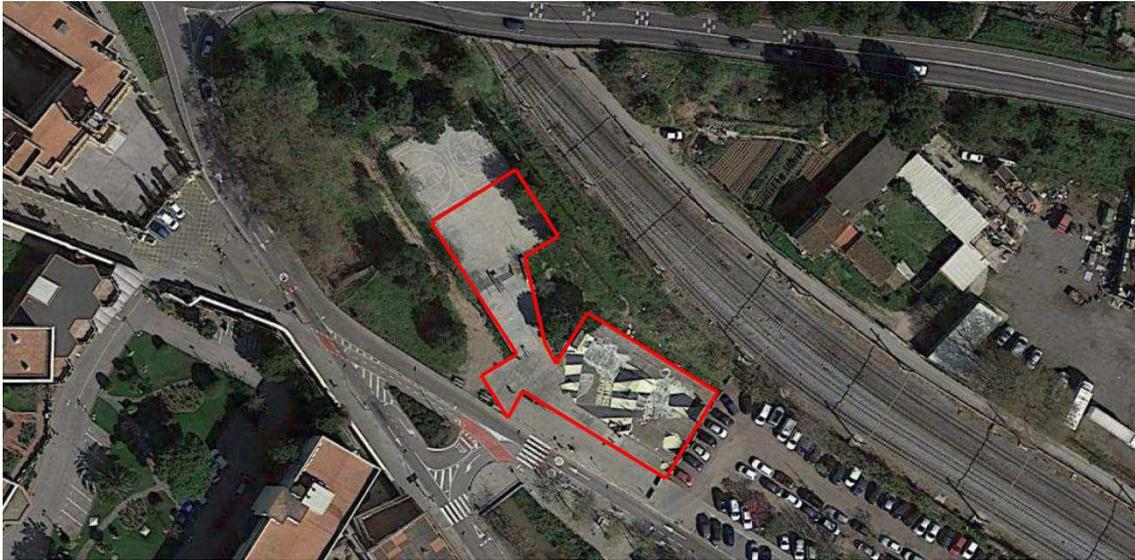
El actual skatepark ocupa una superficie de 1225 m<sup>2</sup>. Ha sufrido diversas reformas y ampliaciones. Inicialmente consistía en una losa de hormigón rectangular sobre la que se disponen una serie de obstáculos prefabricados de estructura metálica y revestimiento de madera y chapa. Actualmente esta zona dispone de dos "quarters" opuestos, otros dos "quarters" más pequeños y un funbox. También incluye dos barandillas de suelo.
